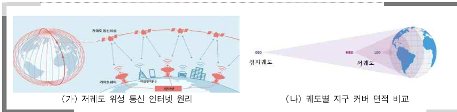
그림 2-2 저궤도 위성 통신 인터넷 원리 및 궤도별 지구 커버 면적 비교
