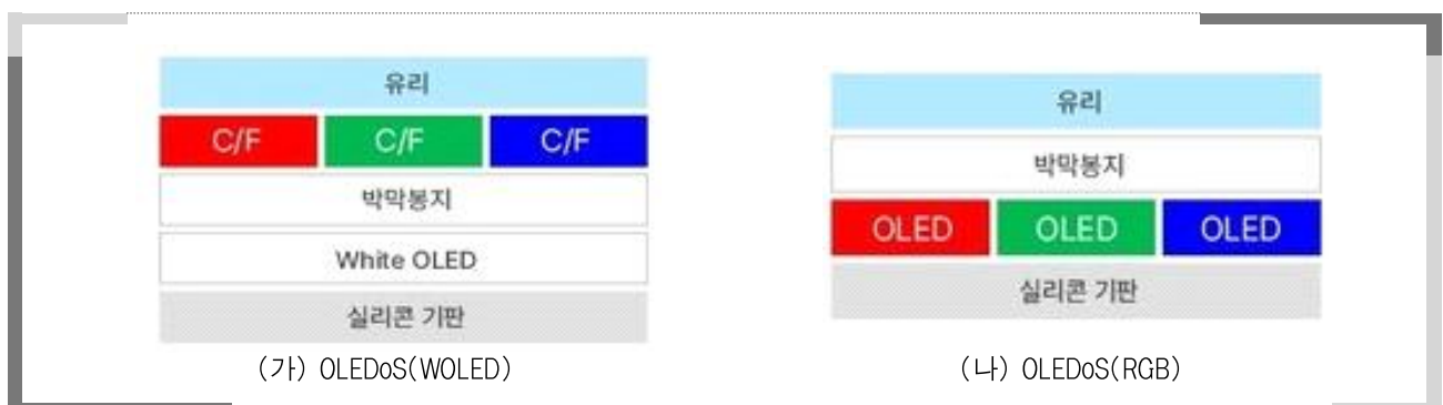
그림 1-6 | OLEDoS 종류별 구조
